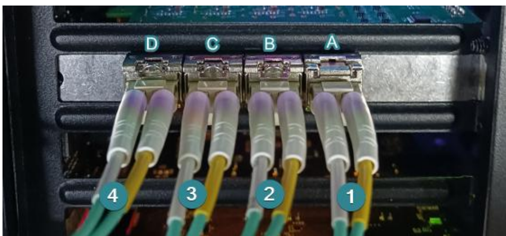
图 3-12 SFP+ 光模块与采集卡连接
