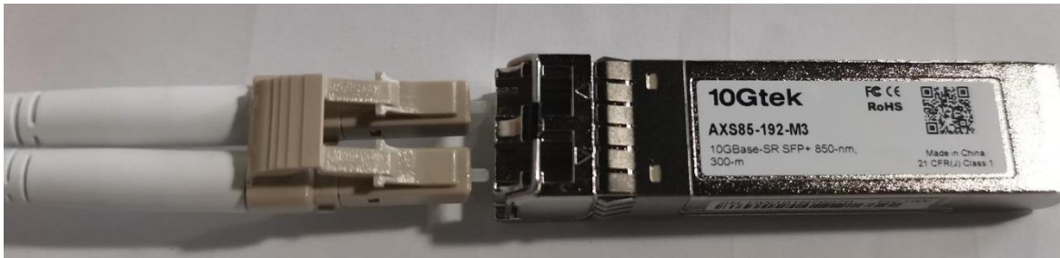
图 3-9 光纤与 SFP+ 光模块连接
