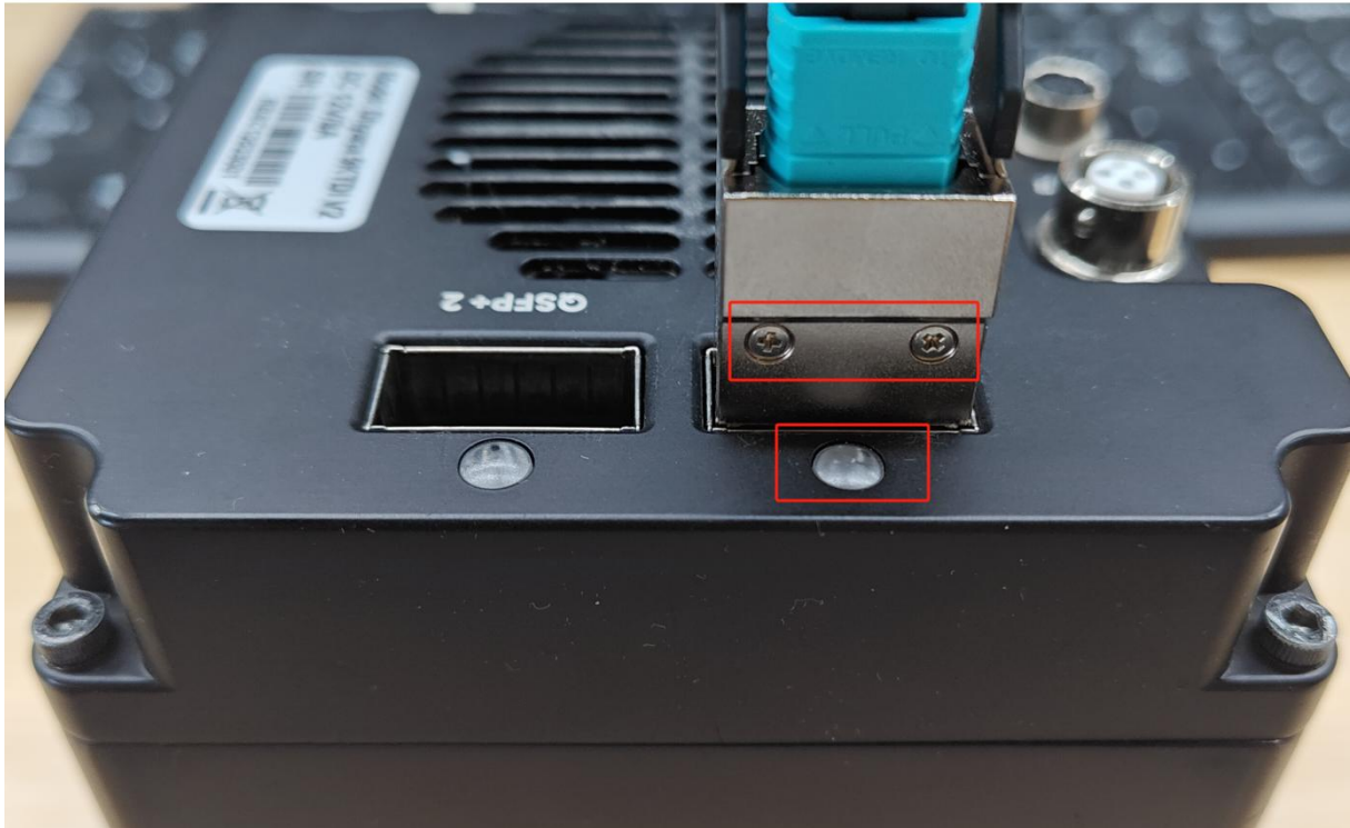
图 3-7 QSFP+ 光模块与相机 QSFP+ 1 端口连接
