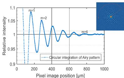
图2: Dhyana 相机 186 eV 光束衍射图
