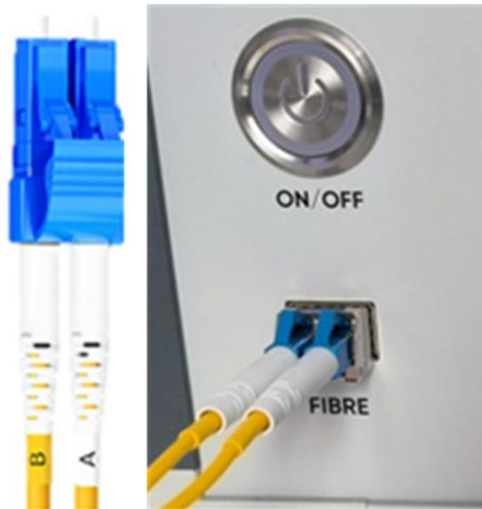
图 4-7 光纤 LC 接头的连接
