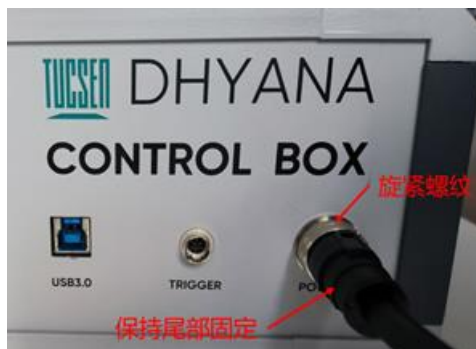
图 4-6 电源触发线连接操作
