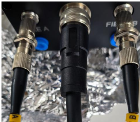
图 4-11 法兰正面连接好电缆和光纤的状态
