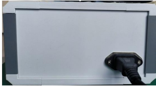
图 4-4 控制盒背面连接好电源线后的状态
