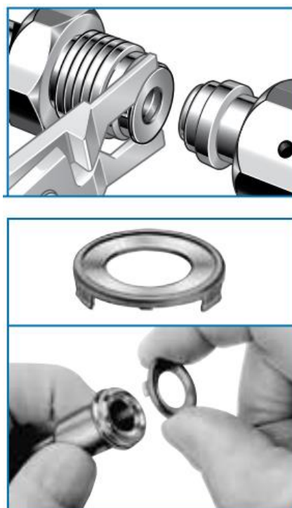
图 4-22 带爪镍垫片的安装
