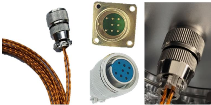
图 4-13 航空插座的接入,左侧为真空腔内线缆,中上为真空侧法兰接口示意图,中下为电缆对应接口示意图,右侧为真空线缆的连接图
