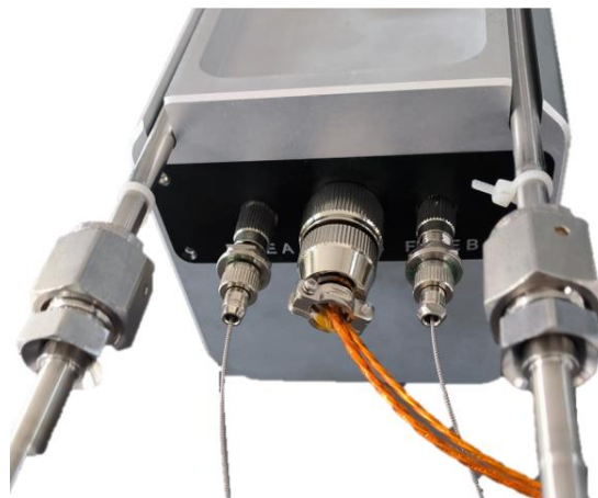
图 4-15 相机端连接好电缆、光纤和水冷管路后的状态
