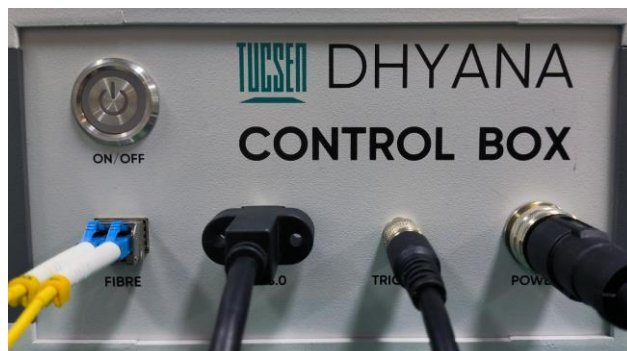
图 4-8 控制盒正面连接好所有线缆后的状态
